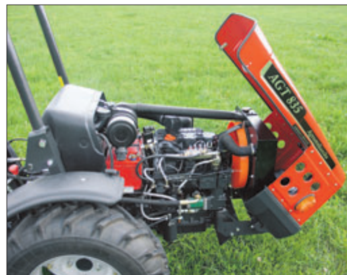
Traktor Agromehanika AGT 835 je prirejen na pogon s čistim rastlinskim oljem po sistemu dveh rezervoarjev in grelnikom olja. Po dostopnih informacijah je v Sloveniji to edini traktor na čisto rastlinsko olje, predelavo pa so naredili na Oddelku za kmetijsko tehniko na KIS-u. Udeleženci posveta so si tako lahko ogledali osebni avto Renault Laguna in traktor na pogon na olje pa tudi stiskalnico za oljnice za decentralizirano (lokalno) stiskanje olja.
